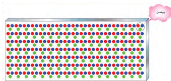
شکل ۳۹-۱۳- پیکسل‌های LED به کار رفته در صفحه نمایش
