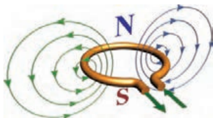
شکل ۱۷-۸ - میدان مغناطیسی حاصل در یک حلقه
