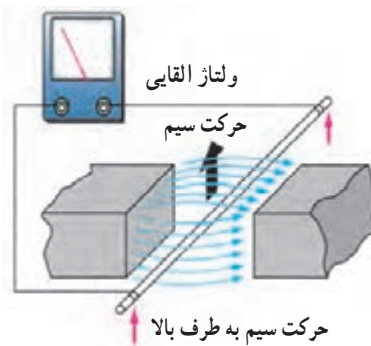
شکل ۸-۲۳ اساس کار یک ژنراتور ساده
