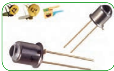
شکل ۴۲-۱۳- شکل ظاهری چند نمونه فتودیود
