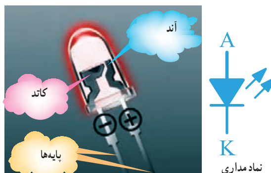
شکل ۳۰-۱۳- نماد فنی و ساختمان داخلی LED
