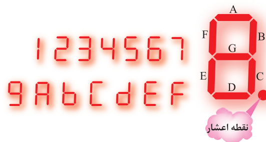
شکل ۱۳-۴۷- روشن کردن هفت قطعه ای
